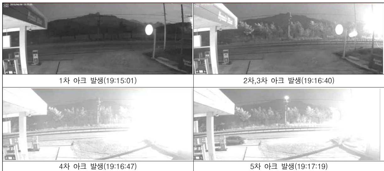
[그림 2] 고성지역 고압선 절단사고 아크 발생
