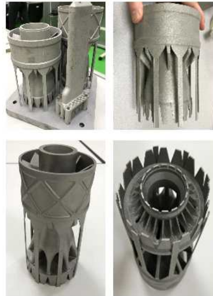
AM 공정을 이용한 연료노즐의 제작
