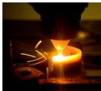
(b) 금속3D프린팅 기술을 이용한 터빈 블레이드 제조과정
