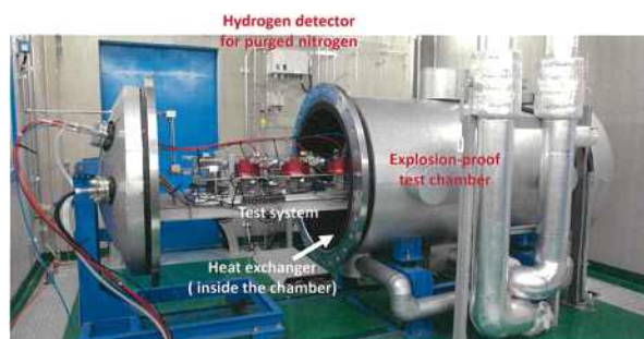
[Hy-TReC: 고압수소시험용 방폭 온도제어 설비]
