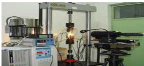
(b) 터빈 블레이드 내구성 시험 전경 (수명 평가(좌), 과속 내구성 평가(우))
