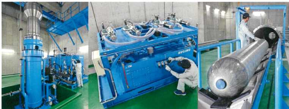
[좌: 반복시험장비(140MPa, 61리터/shot), 중: 파열시험장비(380MPa), 우: 파열율측정]
