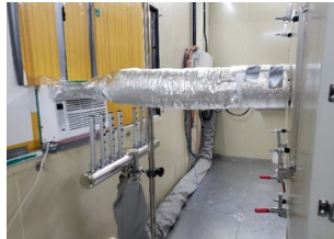
<그림> 엔탈피 공기식 칼로리미터의 장비
