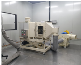
<그림> 엔탈피 공기식 칼로리미터의 장비
