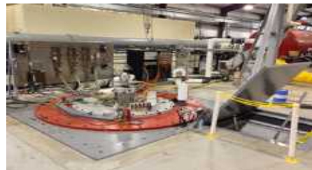
(b) 터빈 블레이드 내구성 시험 전경 (수명 평가(좌), 과속 내구성 평가(우))
