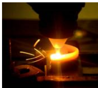
(b) 금속3D프린팅 기술을 이용한 터빈 블레이드 제조과정
