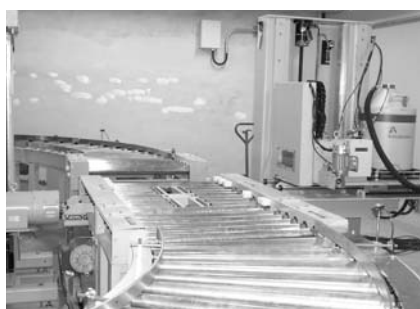
〈그림 3-8〉 드럼핵종분석장치 검출기 및 컨베이어
