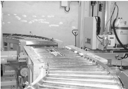
〈그림 3-7〉 드럼핵종분석장치 검출기 및 컨베이어
