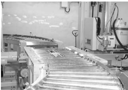
〈그림 3-7〉 드럼핵종분석장치 검출기 및 컨베이어
