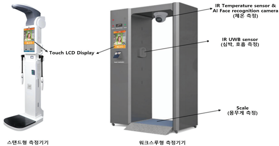
〈그림 3〉 멀티생체신호 측정기기(DHCD) 디자인 예시
