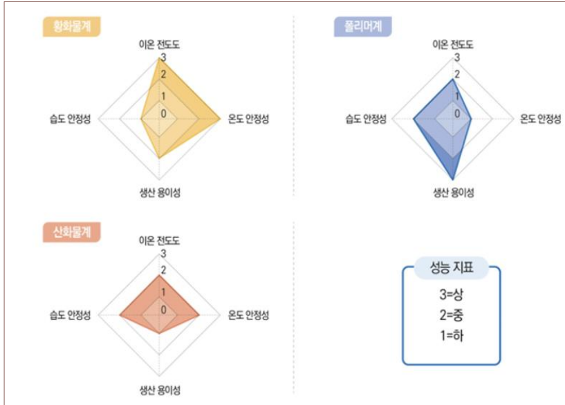
고체 전해질 간 상대 특성(사진=한국과학기술기획평가원(KISTEP) 기술동향브리프 전고체 배터리 편)
