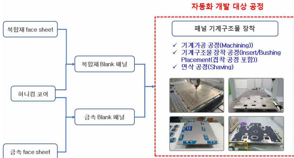
그림 2. 위성체 패널 제작 과정 및 자동화 개발 대상 공정 (예시)
