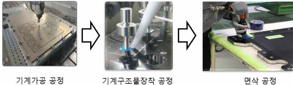
그림 3. 위성체 패널 기계구조물 장착 자동화 공정 (예시)
