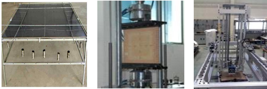
그림 2. 메쉬 인장/전단/충격 시험 (예시)
