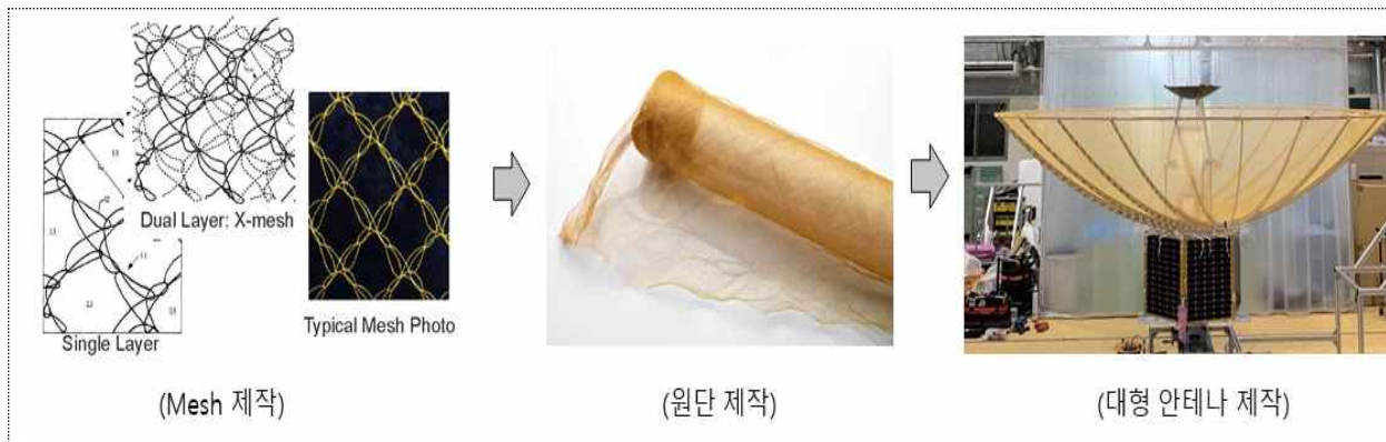
그림 1. 메쉬 개발 형상 및 메쉬를 이용한 성능 검증 안테나 제작 형상 (예시)
