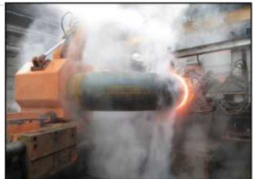
[그림 1] 유도가열벤딩 원리 및 공정
